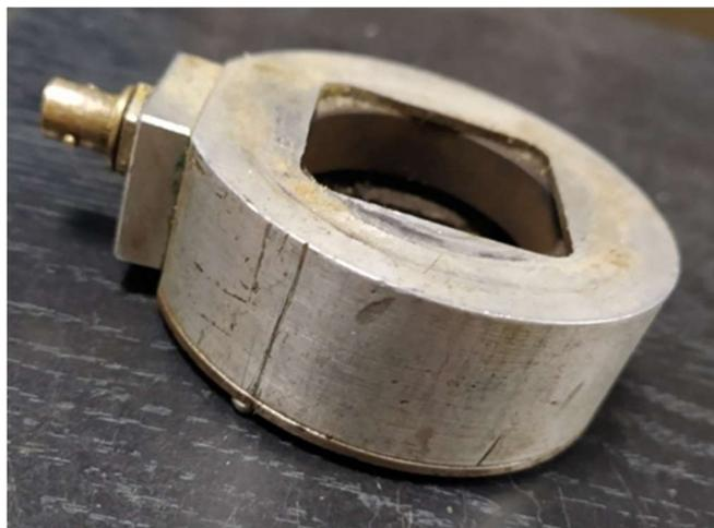
Рисунок 2.2.4 – Электромагнитный датчик для определения напряжения КС
