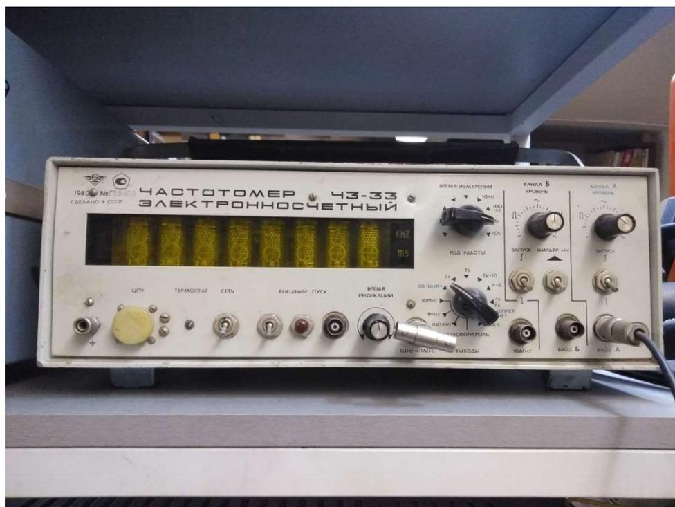
Рисунок 2.2.3 – Частотомер ЧЗ-33
