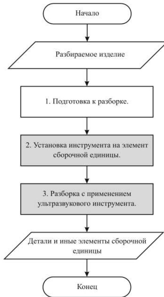
Рисунок 5.2.1 – Блок - схема технологического процесса разборки резьбового соединения с применением ультразвукового инструмента
