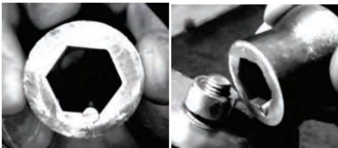
Рисунок 1.2.2–Торцовая головка гаечного ключа с выступом (слева) и процесс монтажа ключа на гайке (справа)
