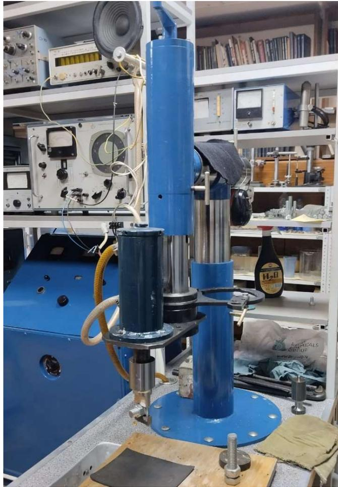
Рисунок 5.3.8 – Пример установки ультразвуковой системы на штативе с 4 степенями свободы
