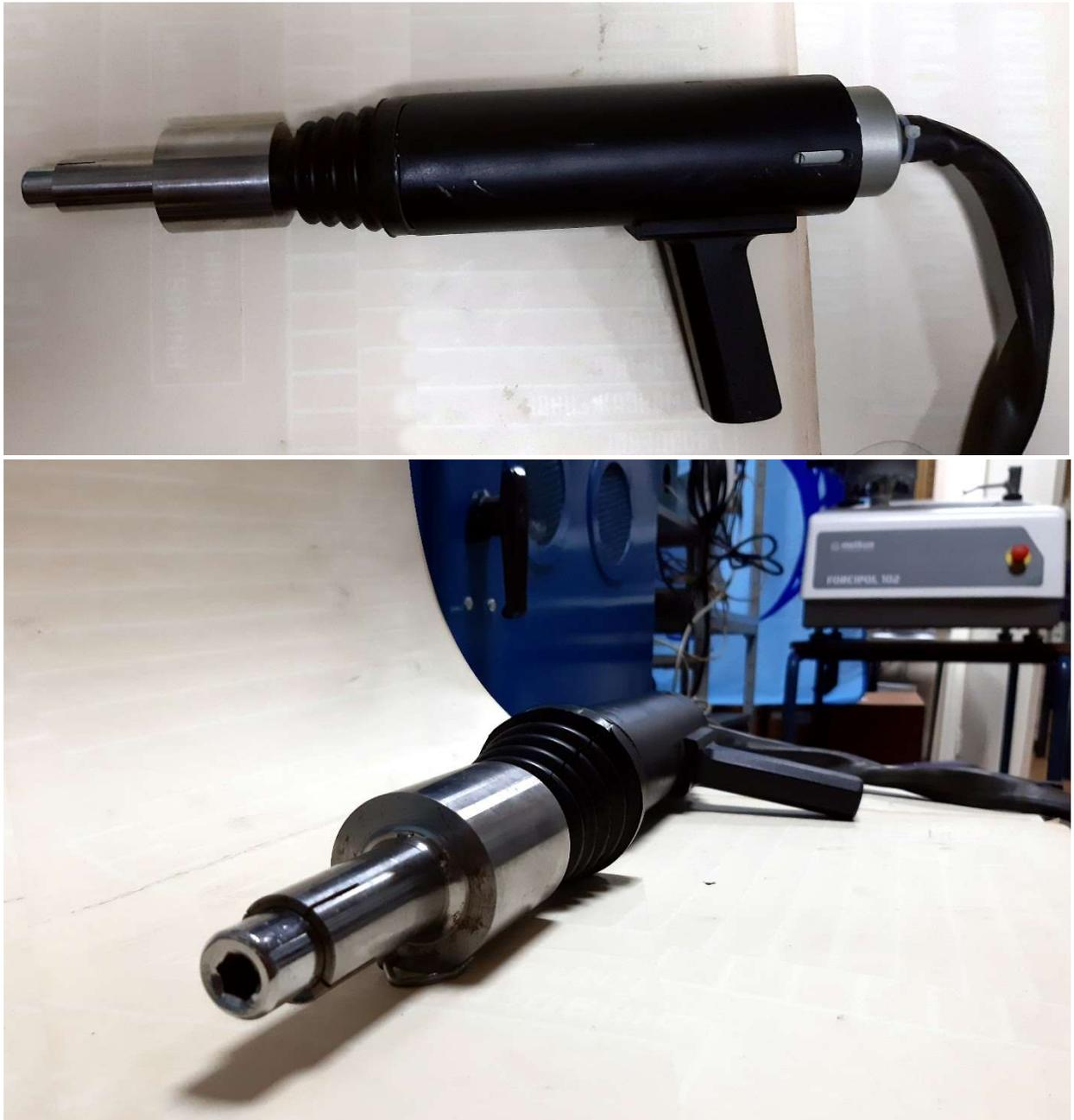
Рисунок 5.3.7 – Магнестрикционная колебательная система с эргономичной рукоятью
