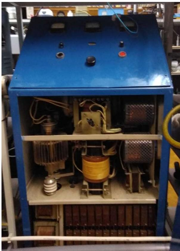
Рисунок 2.2.2 – Ультразвуковой генератор УЗГ5-1.6/22
