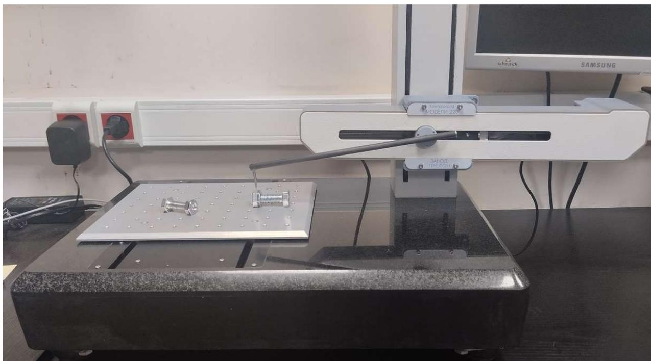
Рисунок 2.3.1 – Контурограф модели 220
