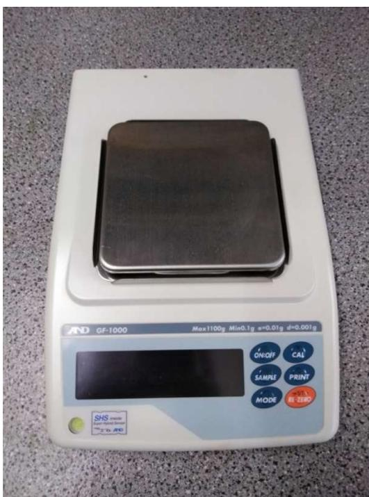
Рисунок 2.3.2 – Лабораторные электронные весы AND GF-1000
